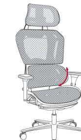
Регулировка высоты спинки / Backrest height adjustment / Артқы биіктікін реттеу
