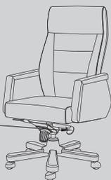
Регулировка жесткости качания /
