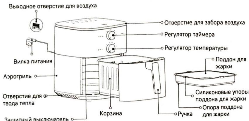
Примечание: силиконовые упоры на поддоне для жарки изготовлены из жаропрочного материала, пригодного для пищевых продуктов, чтобы предотвратить царапание краями поддона для жарки покрытия корзины и улучшить устойчивость поддона для жарки. Не удаляйте силиконовые упоры с поддона для жарки.
