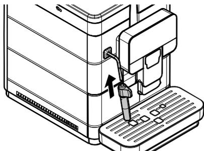
Вставьте всасывающую трубку в емкость, наполненную свежей водой (только версия с Cappuccinatore).
