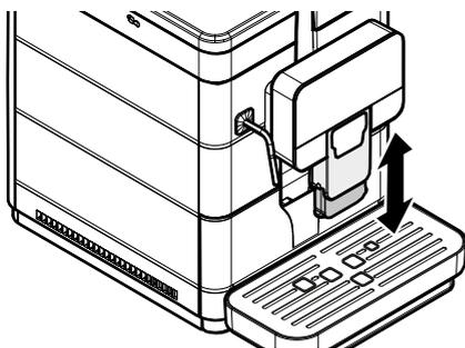
Для выполнения регулировки приподнимите или опустите вручную устройство подачи. Рекомендуемые положения:
