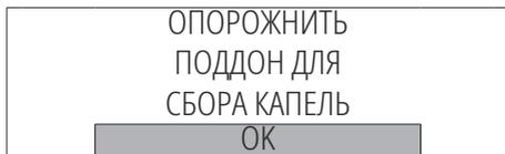
Достаньте и опорожните поддон для сбора капель. Опорожнив поддон для сбора капель, установите его на место. Нажмите кнопку «ОК». Появится следующая страница:
