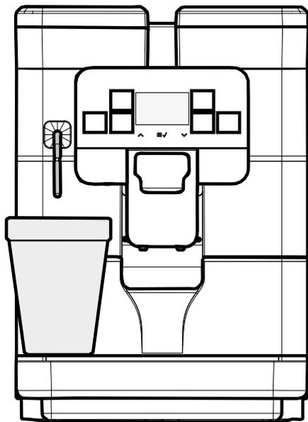
Нажмите кнопку подачи «Hot Water», через несколько секунд из устройства подачи горячей воды начнет выходить горячая вода. На дисплее появится:
