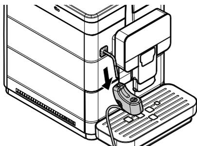
Снимите всасывающую трубку.
