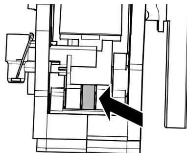
Установите заново блок приготовления кофе в специальное отделение до достижения соединения БЕЗ нажатия на кнопку «PRESS».
