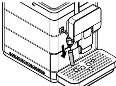
Снимите верхнюю часть насадки Pannarello с трубки пара/горячей воды.
