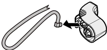
Чтобы снять насадку Cappuccinatore, надавите с двух сторон на внешний кожух и достаньте внутреннюю часть, как показано на рисунке.
