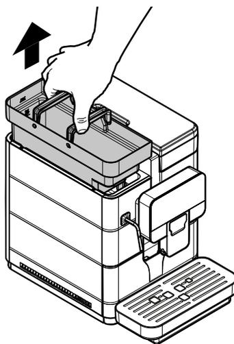
Ополосните и наполните бак свежей водой; не превышайте максимальный уровень (MAX), указанный на баке.
