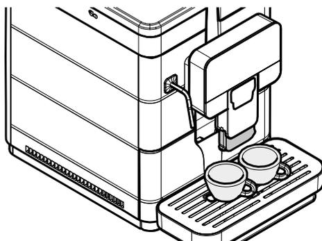
Сдвиньте устройство подачи к машине до упора, чтобы можно было использовать высокие стаканы или MUG. В этом случае за раз возможна подача только одного напитка.
