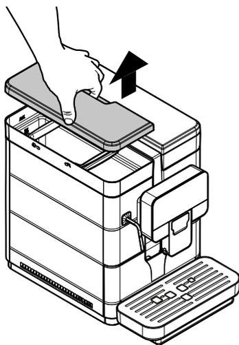
Достаньте бак; поднимите его при помощи специальных ручек, установленных внутри.
