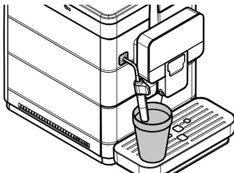
Нажмите кнопку «Manual milk» если на паротводящей трубке установлена насадка Cappuccinatore или нажмите кнопку «Hot Water» если на паротводящей трубке установлена Pannarello. Машине требуется время для подогрева.
