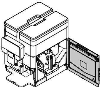
Достаньте блок приготовления кофе, для этого потяните за специальную ручку и нажмите кнопку «PRESS». Блок приготовления кофе можно мыть только теплой водой без моющего средства.
