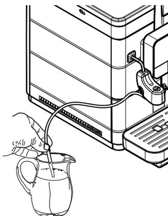
Установите под насадку Cappuccinatore вместительную емкость (1,5 л). Вставьте всасывающую трубку в емкость.
