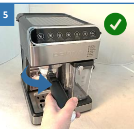
5 Сүзгі ұстағышты кофе қайнатқыш корпусындағы ұяшыққа орнатыңыз
