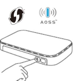
Нажмите кнопку WPS или AOSS™ на беспроводной точке доступа (маршрутизаторе).
