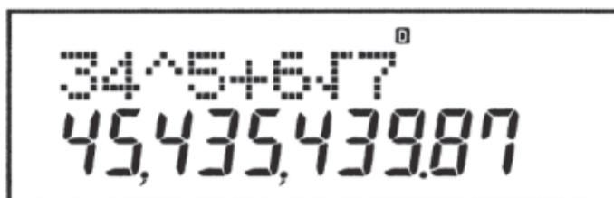
Двухстрочный дисплей обеспечивает возможность одновременного просмотра формулы вычислений и ее результата.
